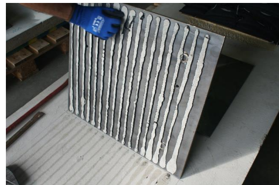
Deutliche Anhaftungen von Estrichschichten auf den am Metall gut haftenden Kleberrauten
